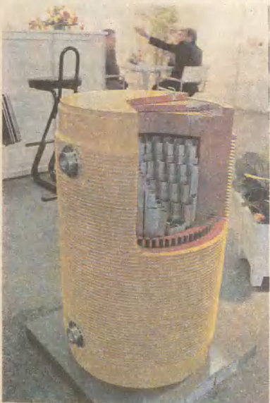
В подобных многослойных контейнерах перевозят радиоактивные элементы.
